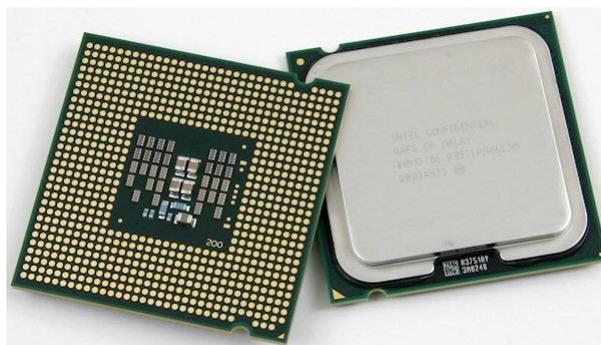
L'unità CPU (Central Processing Unit), indicata anche con il termine **microprocessore** per le sue piccole dimensioni, è il dispositivo che esegue materialmente le operazioni logiche, aritmetiche. L'unità di misura del ritmo con cui svolge le operazioni è il Clock, misurato in Hertz (Hz).
